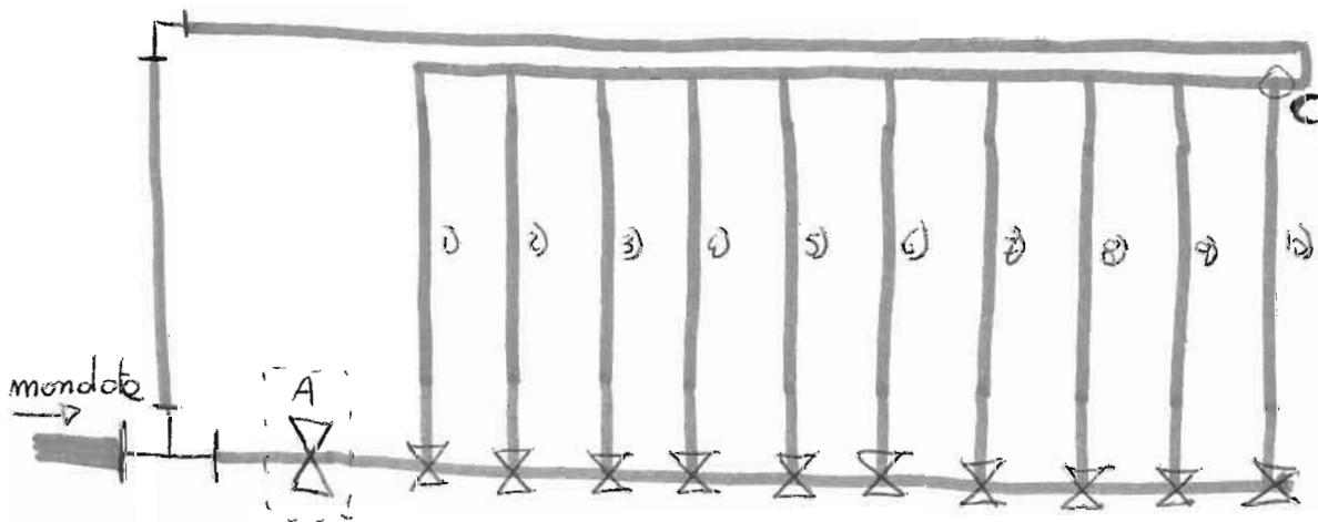
La Valvola A ha la stessa funzione di quella sopra. Questo sistema è il più efficace in termini idraulici, in quanto immette portata nel punto ~~più~~ più critico nel tuo impianto originale (il punto C).
