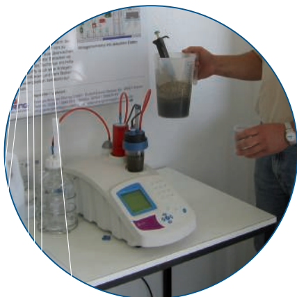
Fig. 1: Il Titolatore automatico TIM 840 di HACH LANGE per la determinazione dei valori FOS/TAC nell'impianto di biogas di Wambeln.
