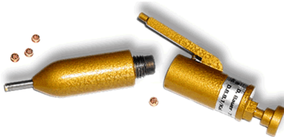
Fig. 3: Esempio di una pistola a proiettile captivo con cartucce
