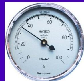
L' IGROMETRO E IL TERMOMETRO sono strumenti indispensabili per definire la umidità relativa (%) e temperatura ( $T^\circ$ ) e ricavarne la umidità assoluta. La pressione atmosferica può variare in funzione del tempo (meteo) della giornata ( + / - mBar). Se la pressione ATM aumenta (=bel tempo) è come se si scendesse di altitudine, ma ha scarso rilievo sulla umidità assoluta.
